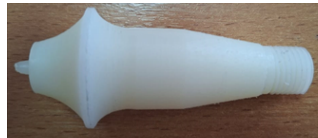
Рисунок 4 – Деталь после обработки по программе, составленной для классической схемы расположения суппорта
