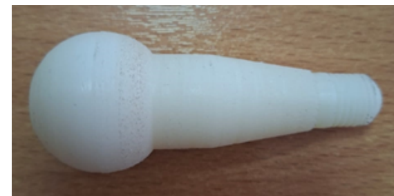
Рисунок 5 – Деталь «шаровой палец», обработанная по приведённой программе
